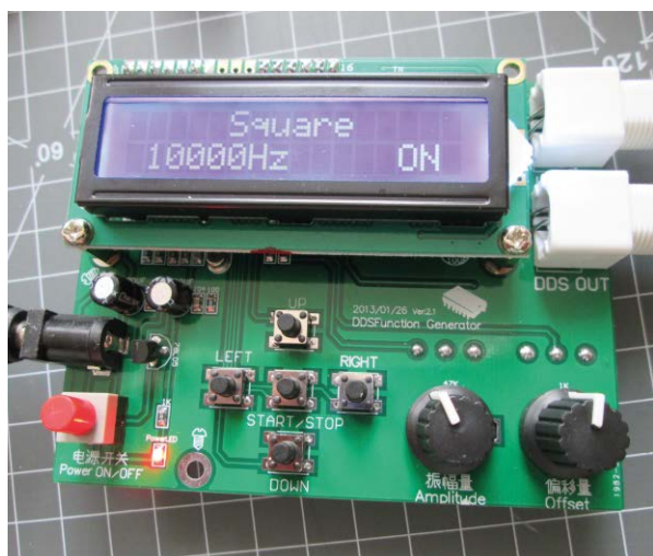
7. Prosty generator sygnałów w oparciu o projekt AVR DDS
